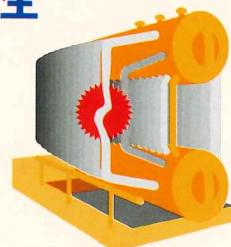
圧力容器の蒸気側ヘッダーに水圧がかかり、温水が流水したため、**パイプ曲がり付近が破損**
